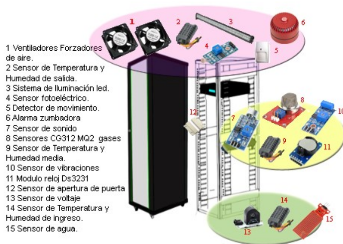
Fig. 3. Sensores y Actuadores que componen el sistema, y zonas de instalación en el rack
