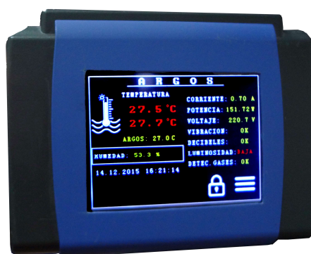
Fig. 8. Unidad externa touch display
